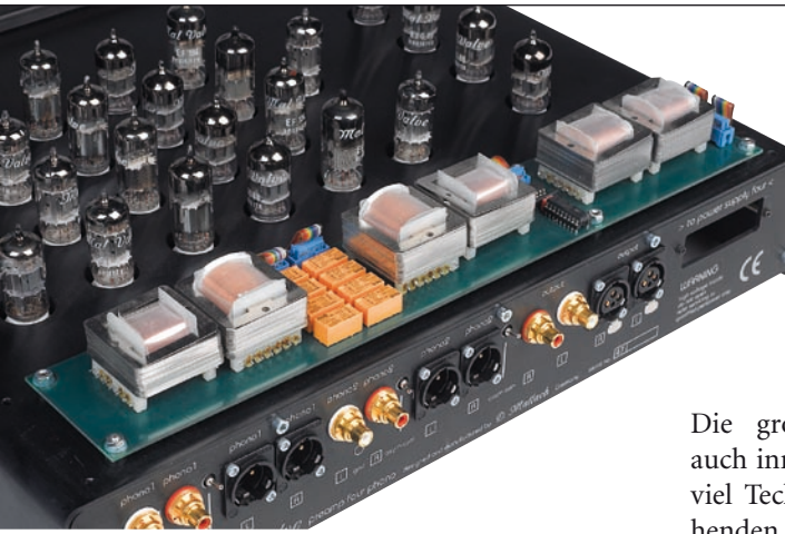
Die große MalValve-Phonovorstufe arbeitet mit gleich sechs Signalübertragern
